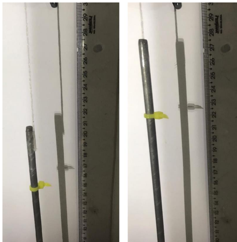
Figura 7 – Técnica de medição de deslocamento vertical utilizada.
